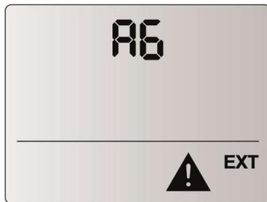
Ein A6 Feueralarm stoppt und sperrt das Luftschleiergerät. Zum Rücksetzen der Blockade muss die Spannungsversorgung ausgeschaltet werden. Die Aktivierung ist mit dem digitalen Eingang „DIN 3“
