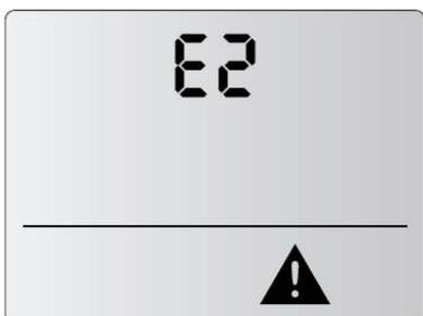
Nur mit dem Clever PRO CONTROL, Der Betrieb von den anderen Einheiten bleibt normal. Ein Luftschleier aus der Gruppe kann nicht gefunden werden. Kontaktieren Sie den Service. Reset erfolgt über Spannung AUS-Schalten.
