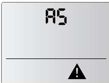
A5 zeigt eine ungeeignete Kombination an, wenn 2 Modelle mit unterschiedlichen Heizungen kombiniert werden (elektrische Heizung [E] mit PWW waassererwärmter Heizung [P] oder mit Wärmepumpen-Heizung [DX]). Erlaubt ist, unbeheizte Modelle mit Umluft [A] und Modelle mit Heizung zu kombinieren.
